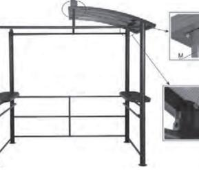
Die Dachplatten komplett bündig und fest in die Profile einschieben! Es dürfen keine Zwischenräume entstehen!
