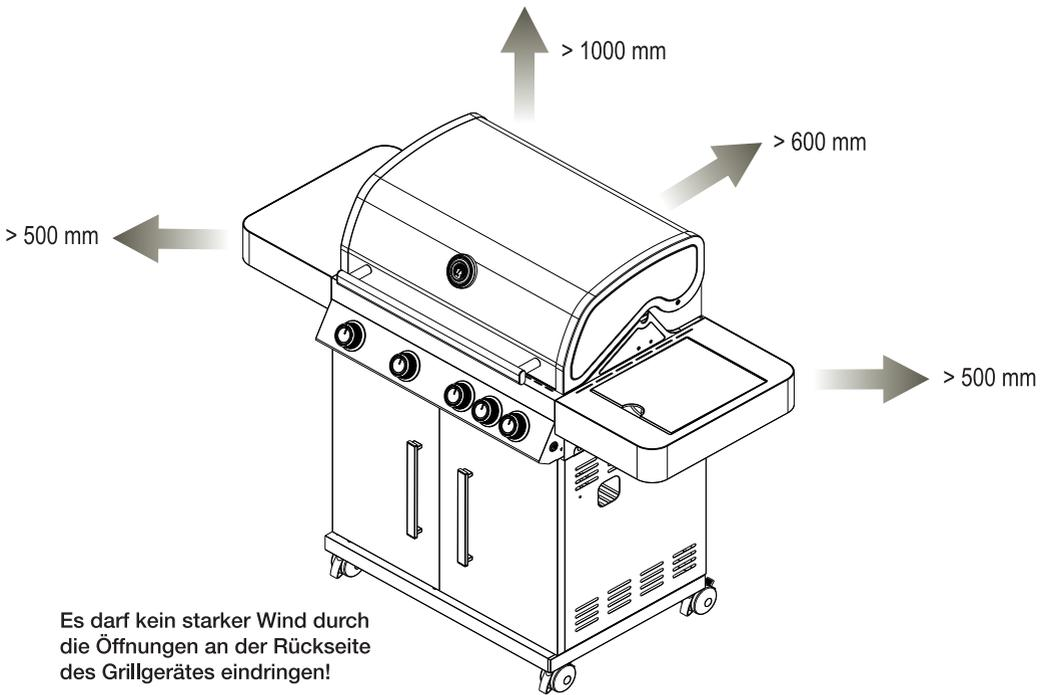
**Es darf kein starker Wind durch die Öffnungen an der Rückseite des Grillgerätes eindringen!**
